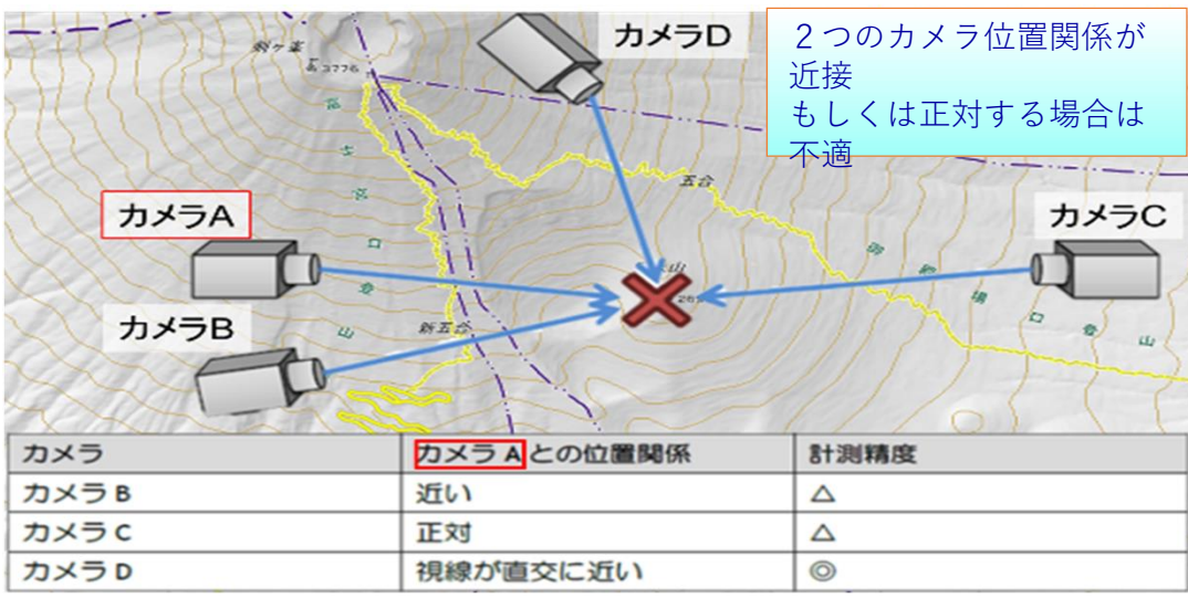
図-5 手法2による座標推定のイメージ
