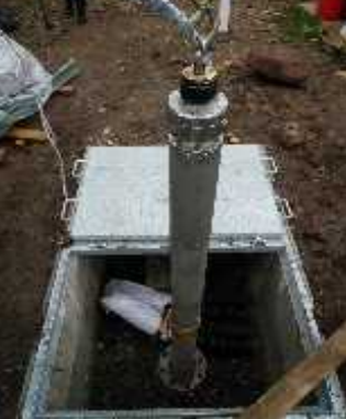
観測孔に埋設される傾斜計センサー
