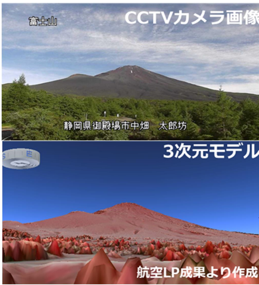
図-3 3次元モデルとカメラ画像の重ね合わせ
